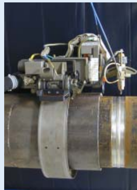
Abbildung 4: Schweißfahrwerk Polycar MP mit Standardbrenner zum Engspaltschweißen bis 40 mm Wandstärke
