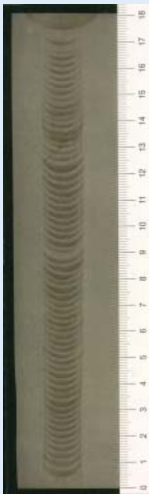
Abbildung 3: Heißdraht-Engspalt-Schweißnaht, eine Schweißung pro Lage - Wandstärke 180 mm, Grundwerkstoff: niedrig legierter Stahl P91
