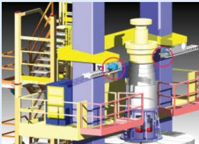
Abbildung 6: Mit zwei WIG-Heißdraht-Engspaltbrennern ausgestattete Schweißstation zum Fügen von Turbinenrädern
